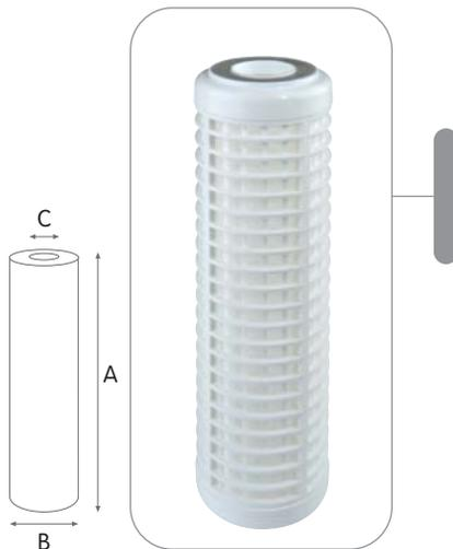
Le cartucce in rete lavabile con filtrazione nominale 50 micron consentono un flusso uniforme d'acqua e perdite di carico molto basse. Le cartucce vengono prodotte senza colla e sigillanti, e le reti vengono stampate sul supporto rigido strutturale (armatura). Cartucce con supporto rigido progettate per elevata resistenza e durata, con altezza da 4" a 20".
